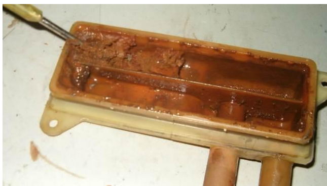
Depósito de refrigerante con lodo y otros minerales cuando no se aplica lo adecuado
