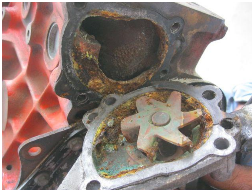
Bomba de Agua de un motor descuidado, con corrosión, impide un buen trabajo de refrigeración al motor
