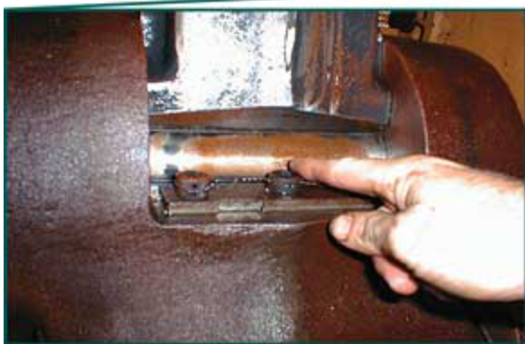
Figura 2. Herrumbre en el pasador de biela
